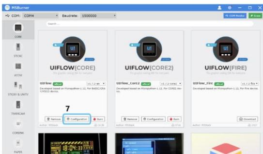
**Schritt 7:** Jetzt geht es darum, das Gerät zu konfigurieren. Klicken sie dafür auf den Button «Konfigurieren».
